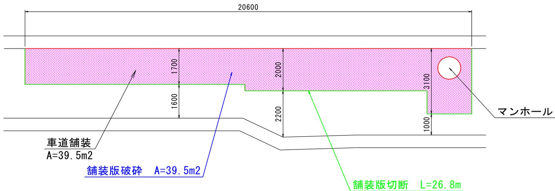
構造物取壊し工および舗装工数量算出根拠図
